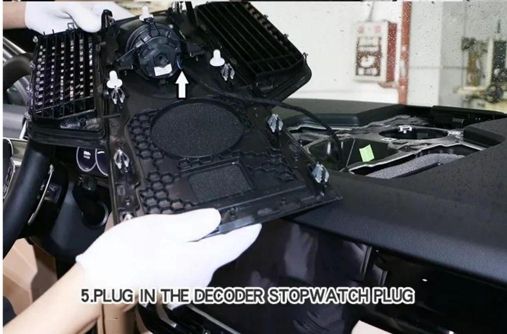
**5.PLUG IN THE DECODER STOPWATCH PLUG**
