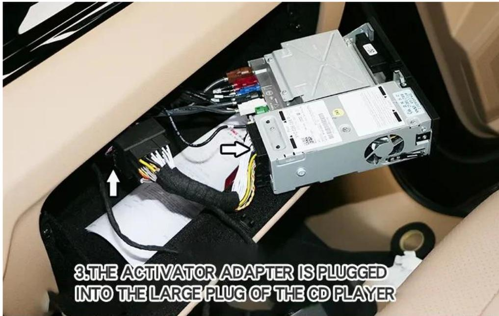
**3.THE ACTIVATOR ADAPTER IS PLUGGED INTO THE LARGE PLUG OF THE CD PLAYER**
