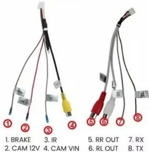
1. BRAKE 2. CAM 12V 3. IR 4. CAM VIN 5. RR OUT 6. RL OUT 7. RX 8. TX
