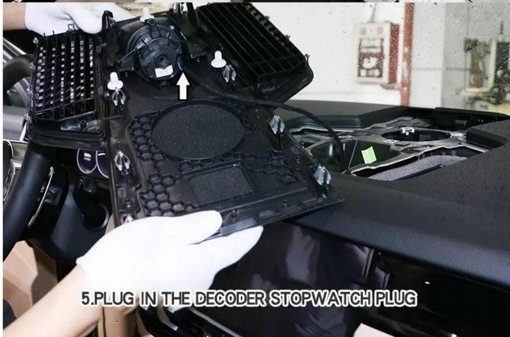
5. PLUG IN THE DECODER STOPWATCH PLUG
